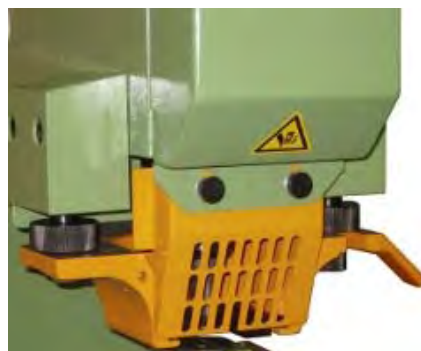
dévêtisseur pivotant et réglable en hauteur
