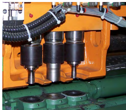
Dreistempel-Werkzeug, schaltbar, für FPDB Triple tool assembly to suit FPDB lines Dispositif de trois poinçons à sélection, pour la ligne FPDB
